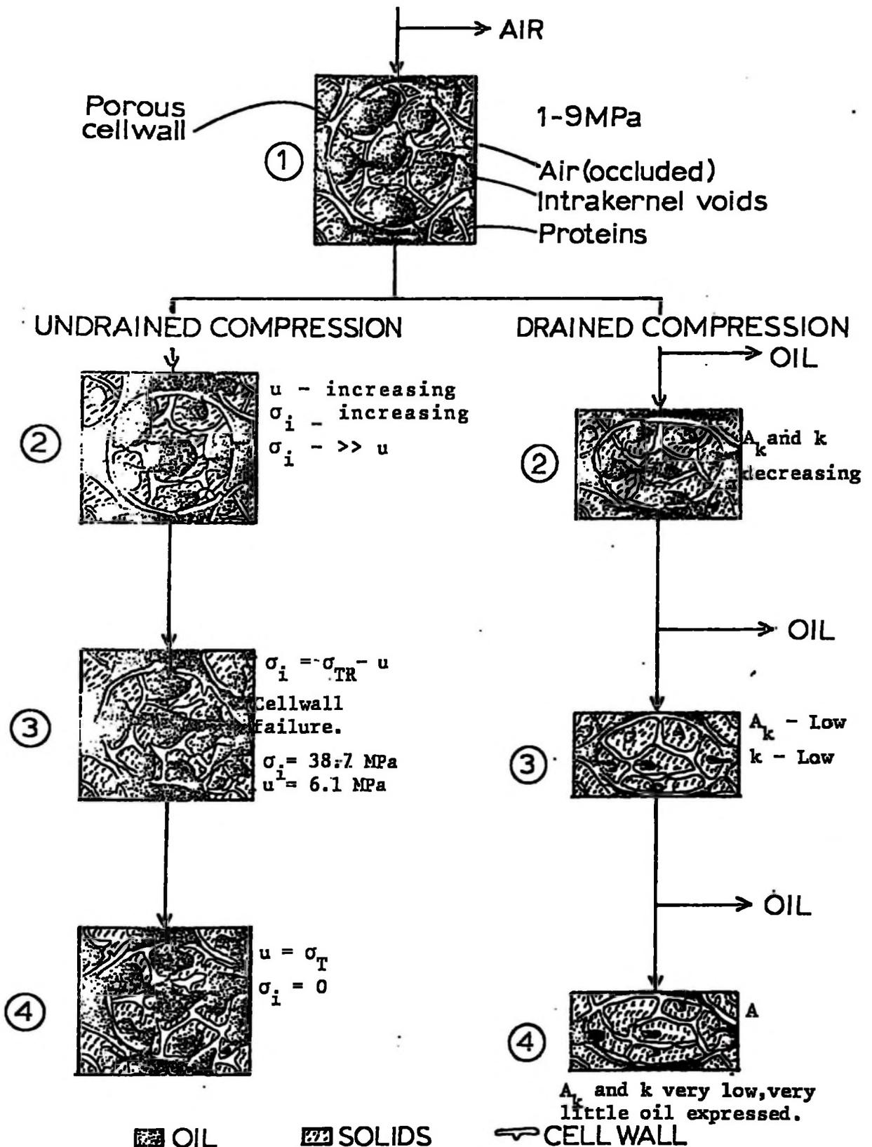
FIG: 49 A PHYSICAL MODEL OF THE OIL EXPRESSION PROCESS.
