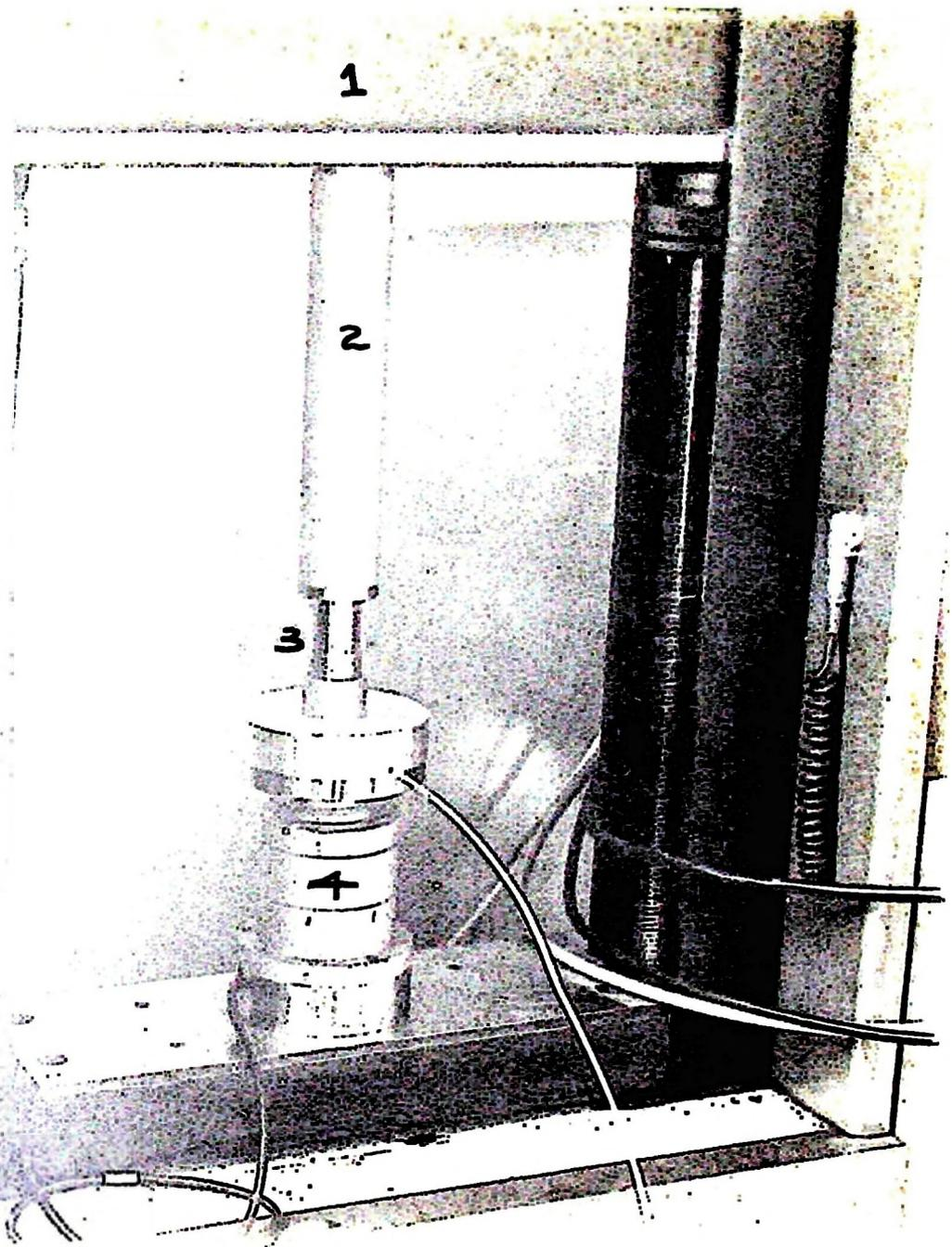
FIG. 5. EXPRESSION RIG ON THE CONSTANT RATE OF STRAIN INSTRON UNIVERSAL TESTING MACHINE.
